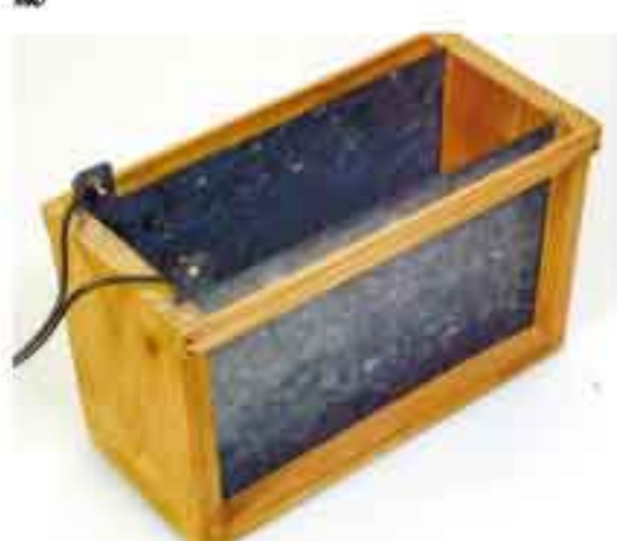
終戦後に使用された電熱式のパン焼き器 (平塚市博物館所蔵)
